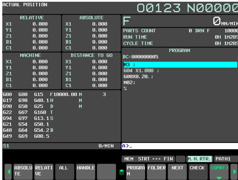
Fig. 5.3.5 (a) "M.H.RTR." status display
