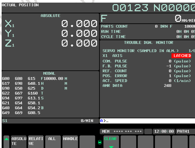
Fig.18.4.4 (d) Trouble diagnosis monitor screen (10.4-inch display unit)
